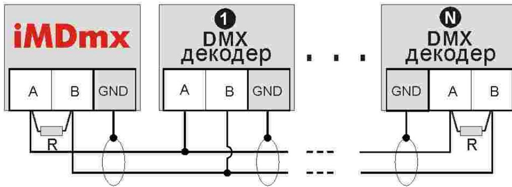
При длине линии больше 20 метров рекомендуется линию синхронизации выполнять экранированной витой парой FTP-5e. На первом и на последнем контроллере необходимо установить между клеммами А и В волновое сопротивление – резистор на 120 Ом, 0,25 Вт.
