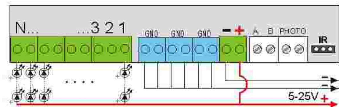
**Подключите контроллер** клеммы + и - к блоку питания.
