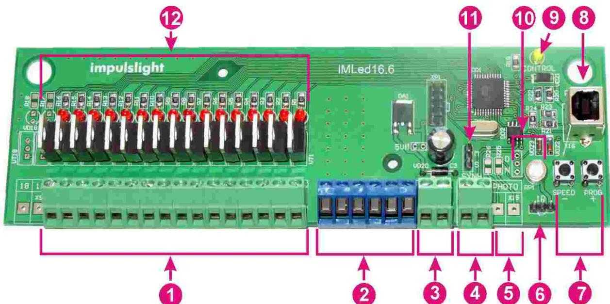
1. Клеммы подключения нагрузки
