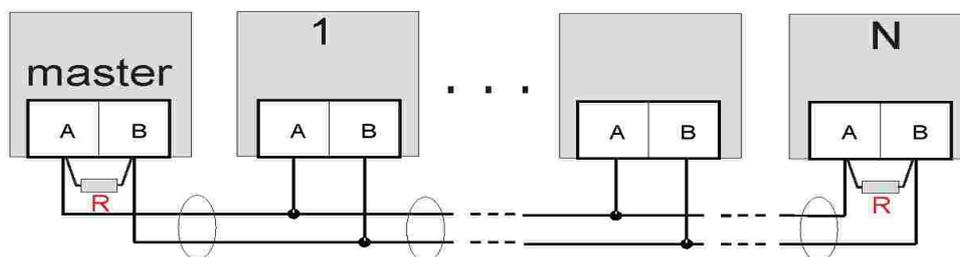
**В режиме «Master»** контроллер передает команды синхронизации другим контроллерам. Во время посылки команды происходит мигание индикатора CONTROL (поз.9). **В режиме «Slave»** данный индикатор должен светиться постоянно. Если индикатор в режиме «Slave» не горит, это означает отсутствие связи с Мастером. Следует проверить кабель синхронизации и правильность установки режимов «MA/SL» на всех контроллерах.
