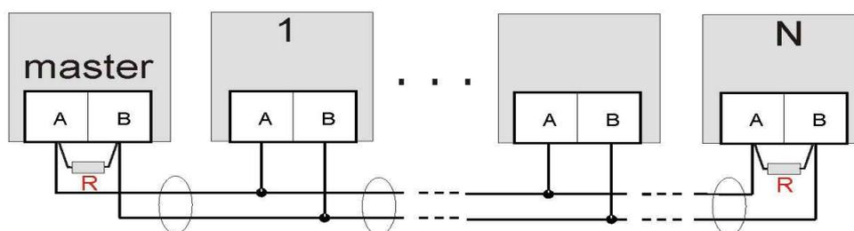
**В режиме «Master»** контроллер передает команды синхронизации другим контроллерам. Во время посылки команды происходит мигание индикатора CONTROL (поз.7). **В режиме «Slave»** данный индикатор должен светиться постоянно. Если индикатор в режиме «Slave» не горит, это означает отсутствие связи с Мастером. Следует проверить кабель синхронизации и правильность установки режимов «MA/SL» на всех контроллерах.
