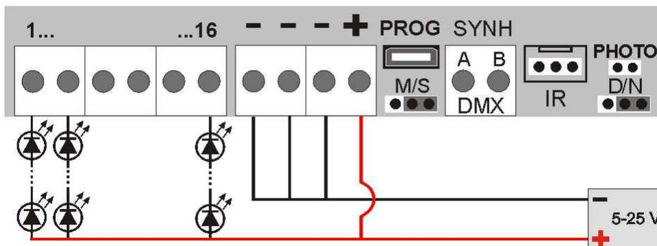
**Подключите контроллер** клеммы + и одну клемму GND(-) к блоку питания.
